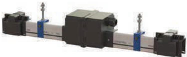
Conjunto formado por una caja de acometida intermedia con un prensaestopas M25x1,5, dos tramos de barra conductora de 300mm cada uno, dos punto fijos RGMM05, así como dos empalmes de línea RGMM02.
