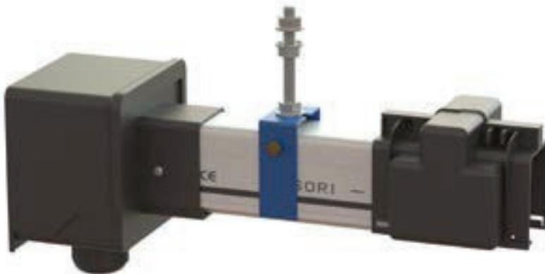
Conjunto formado por una caja de acometida con prensaestopas M25x1,5, un tramo de barra conductora de longitud 205mm, punto fijo RGMM05 y empalme de línea RGMM02.
